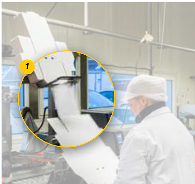
1) Emnet hentes fra magasinet og legges på jiggen. Et anslag sørger for at det havner på rett plass.
